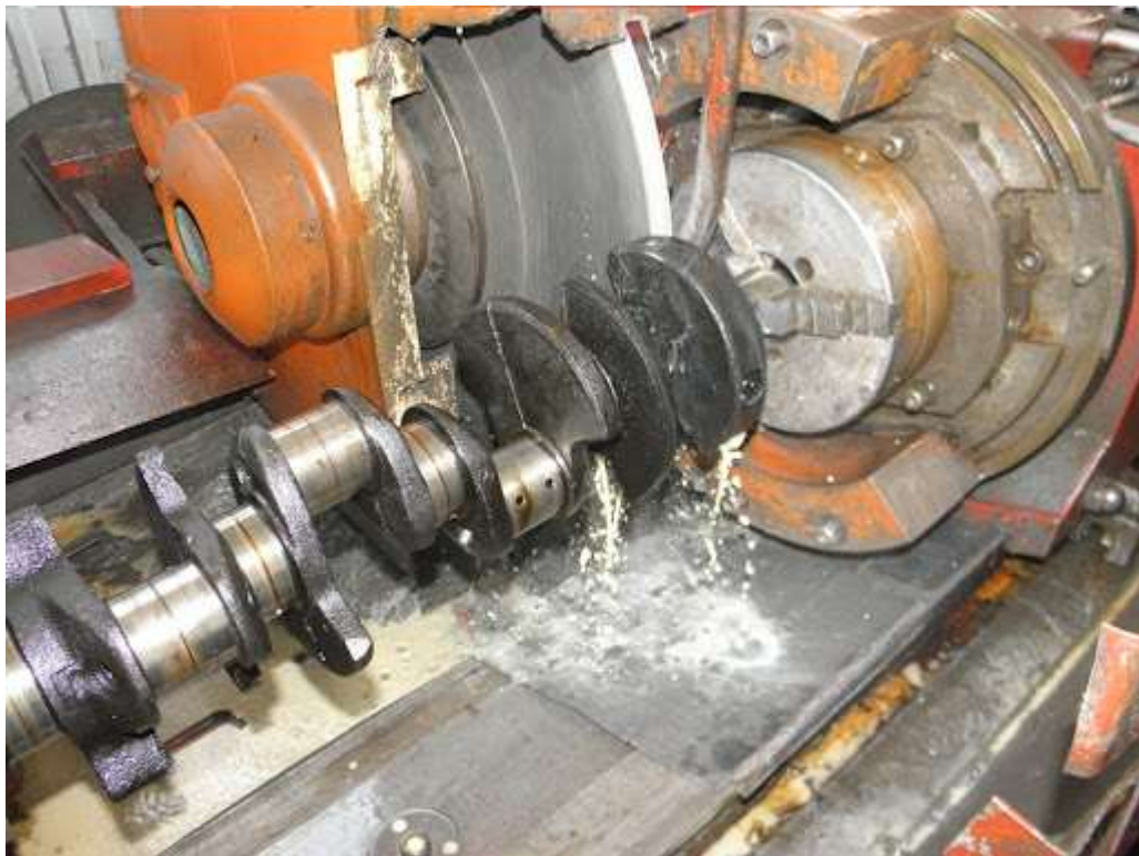
Рис. 2 – Шліфування колінчастого валу
