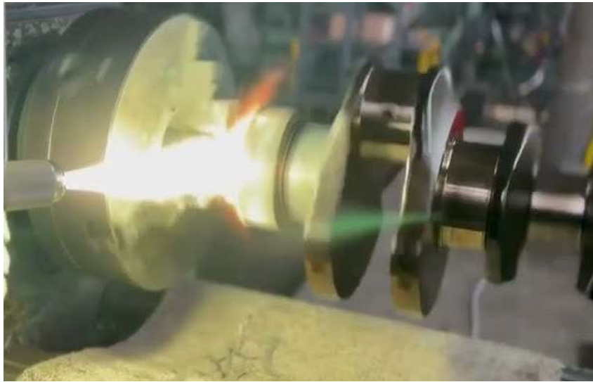
Рис. 3 – Наплавлення колінчастого валу
