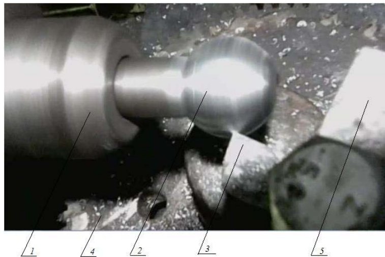
Рис. 9. Фрагмент процесу токарної обробки сфери кульового пальця з використанням поворотного пристрою: 1 – спеціальна оправка; 2 – заготовка; 3 – різець; 4 – поворотний стіл; 5 – різетримач
