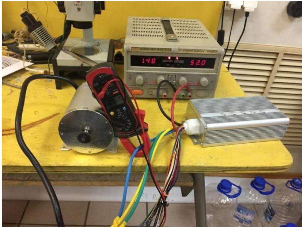
Рисунок 5.6-Діагностика електродвигуна по струму, що споживається обмотками статора на режимі холостого ходу
