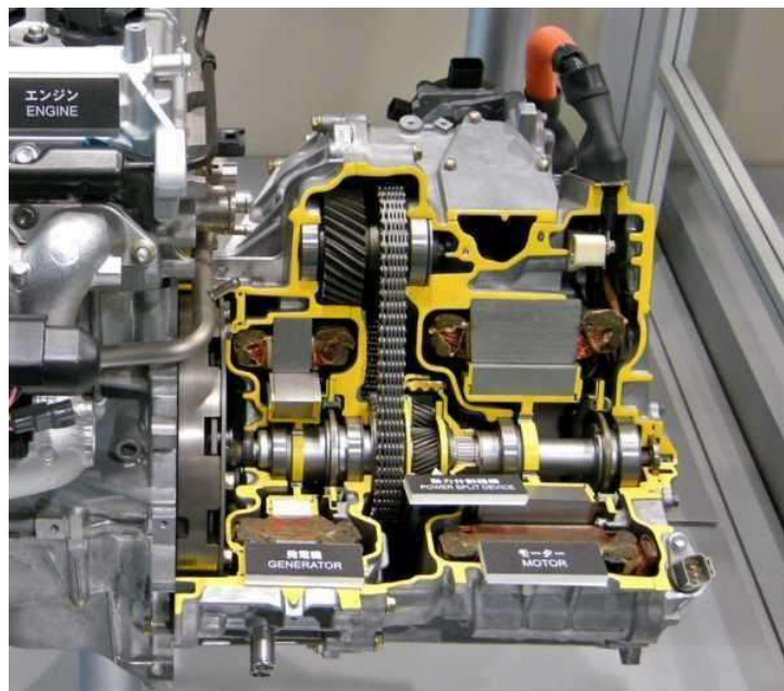
Рисунок 2.4 – Гібридна силова установка у розрізі
