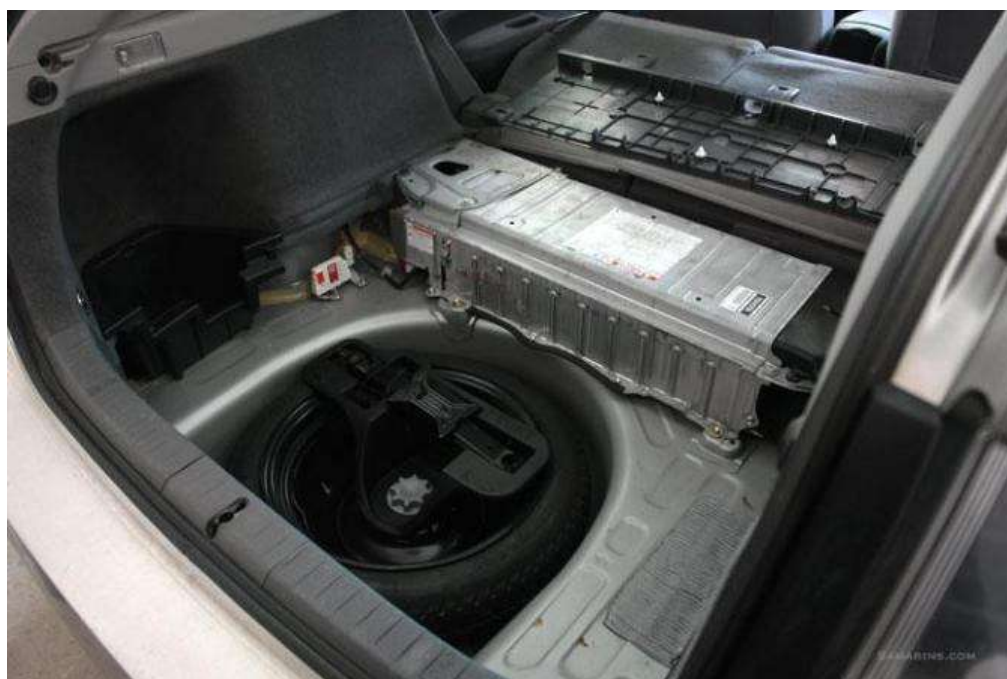
Рисунок 3.3 – Місце розташування акумуляторної батареї багажнику автомобіля
