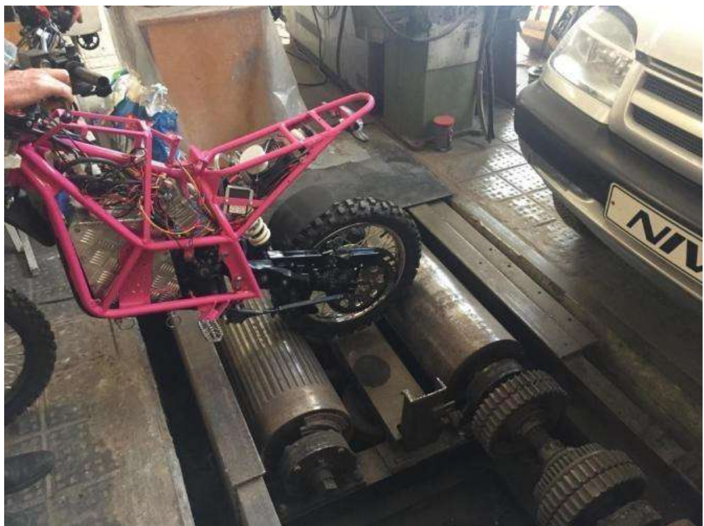
Рисунок 5.5-Визначення потужності на провідному колесі електричного мотоцикла з динаміки розгону
