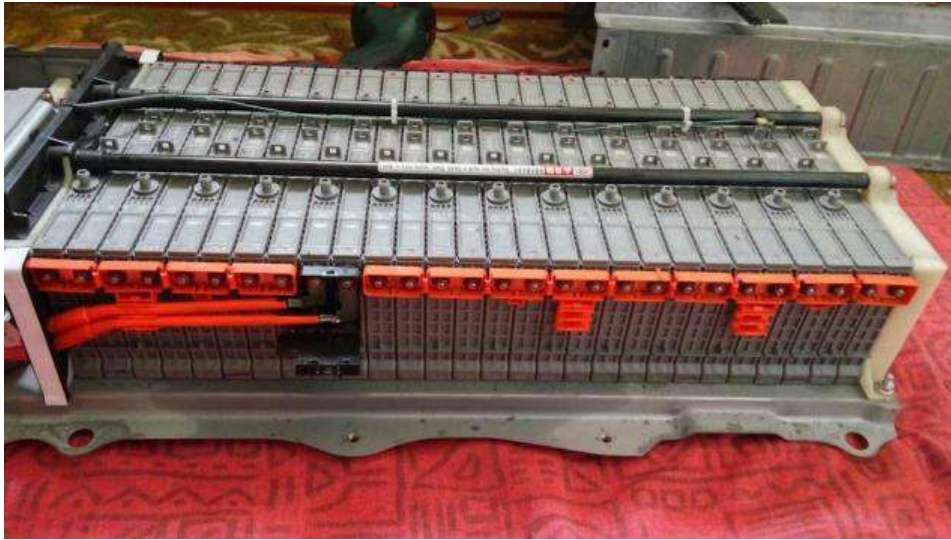
Рисунок 3.2 – Зовнішній вигляд нікель-металогідридної батареї Toyota Prius
