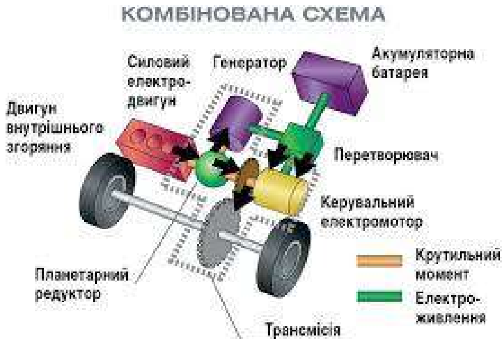
Рисунок 2.10 – Послідовно-паралельна (змішана) схема компоновання автомобіля з гібридною силовою установкою
