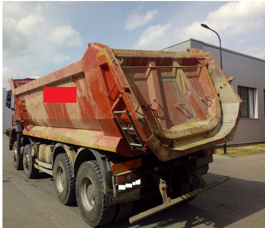
Rys. 17. Pojazd po szkodzie z uszkodzoną ramą nośną oraz pomocniczą (opracowanie własne)
