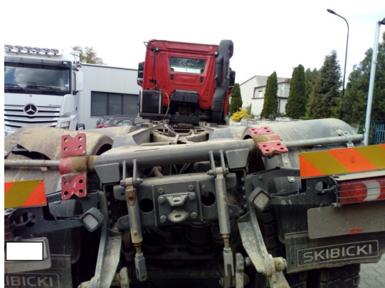
Rys. 18. Deformacja ramy nośnej oraz pomocniczej w pojeździe ciężarowym po demontażu skrzyni ładunkowej (opracowanie własne)
