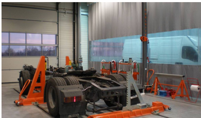
Rys. 14. Stanowisko naprawcze ram Blowtherm system Cellete z wykorzystaniem podpór [4]
