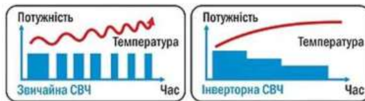
Рисунок 1.7 – Звичайні та інвертовані трансформатори для мікрохвильових печей:
