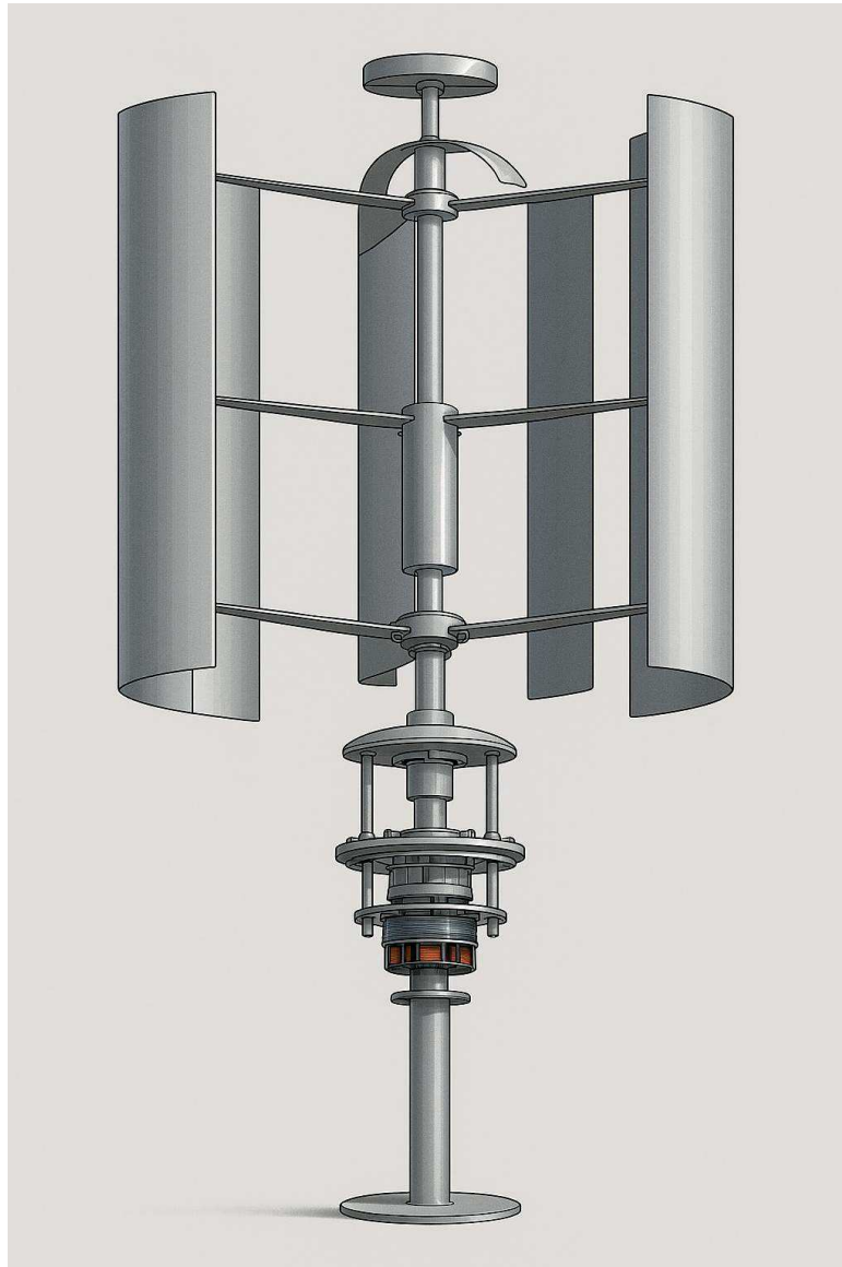
Рисунок 2.2 – Об’ємна 3D-модель вертикально-осьового вітрогенератора типу Дар’є
