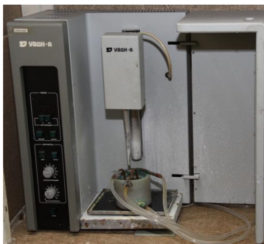
Рис.2.1. Загальний вигляд установки УЗДН-А для проведення кавітаційно-ерозійних випробувань
