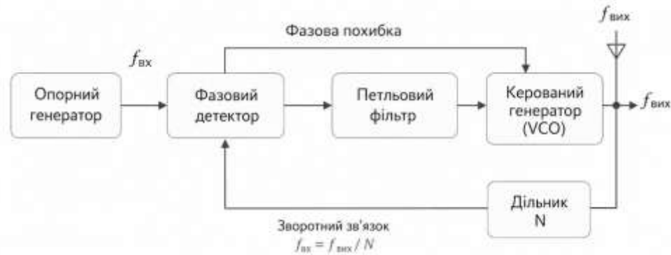
Рисунок 3.4 – Структурна схема синтезатора частоти на основі PLL
