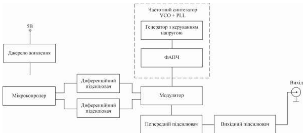
Рисунок 3.1 – Структурна схема пристрою формування ЛЧМ сигналу
