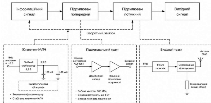
Рис. 9 – Структурна схема тракту підсилення сигналу
