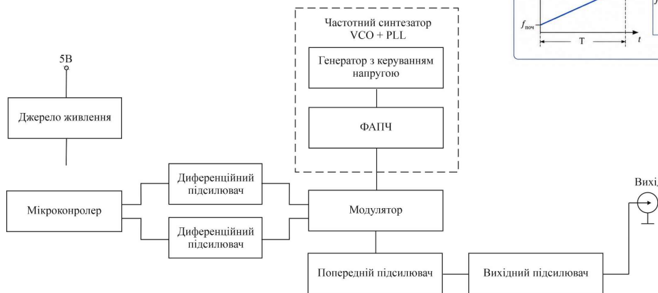
Рис. 3 – Структурна схема пристрою формування ЛЧМ сигналу
