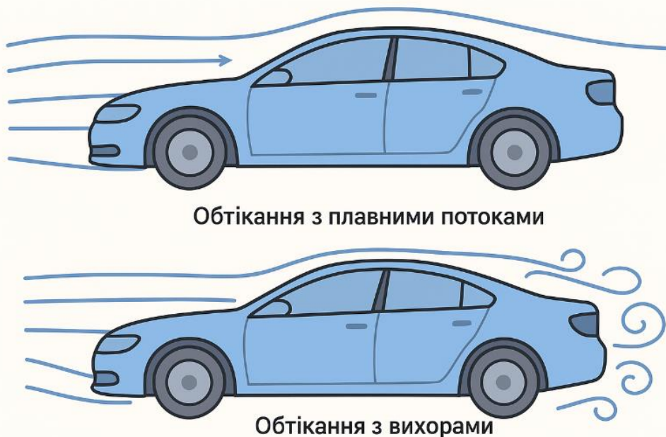
Рисунок 1 – Обтікання тіла повітряним потоком
