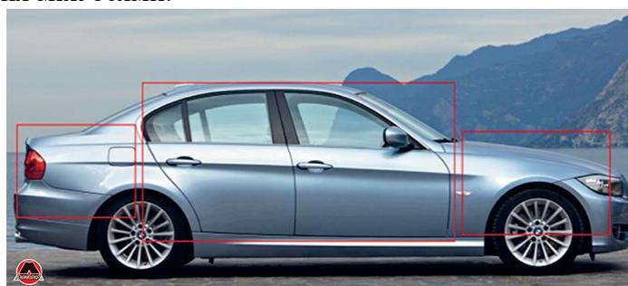
Рисунок 9 – Приклад трьохоб'ємного кузова.
