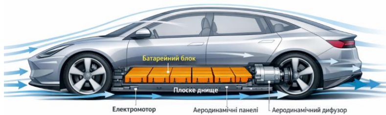
Рисунок 21 – Розташування батарей і оптимізація днища для ефективної аеродинаміки.
