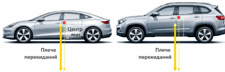
Рисунок 14 – Порівняння розташування центра мас у легкового автомобіля та SUV
