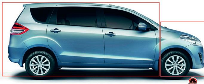
Рисунок 8 – Приклад двохоб'ємного кузова.
