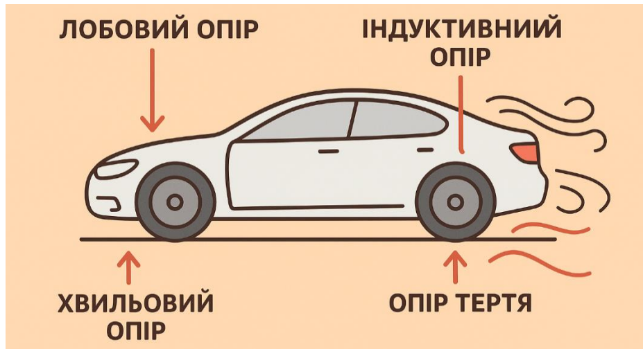
Рисунок 2 – Опір повітря та його складові
