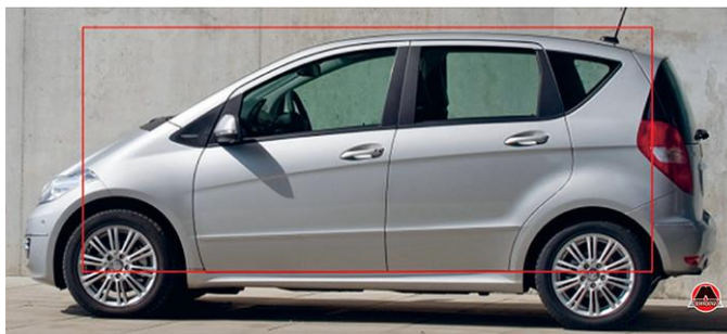
Рисунок 10 – Приклад однооб'ємного кузова.
