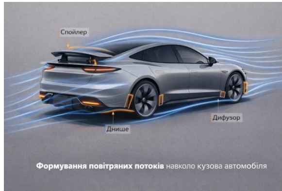
Рисунок 15 – Формування повітряних потоків навколо кузова автомобіля
