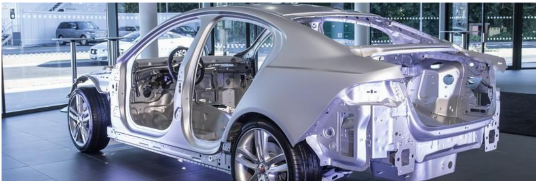
Рисунок 24 – Використання алюмінієвих сплавів у сучасних автомобілях
