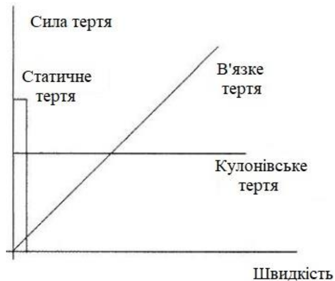
Рисунок 1.5 – Графіки залежності сили тертя від швидкості
