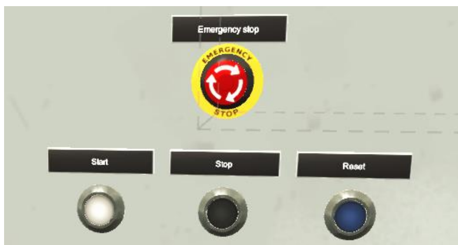
Рисунок 4.11 - Кнопки ПУСК, СТОП, СКИДАННЯ та аварійної зупинки
