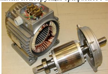
Рис. 2. Конструкція трифазного асинхронного двигуна [1]
