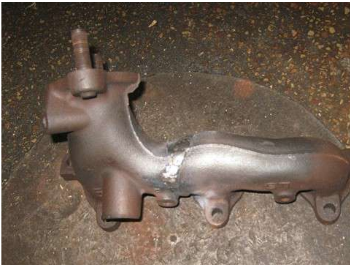
Рисунок 7 – Відремонтований випускний колектор
