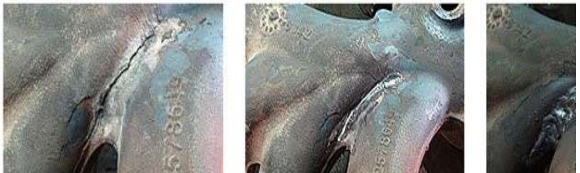
Рисунок 8 – Етапи ремонту випускного колектора
