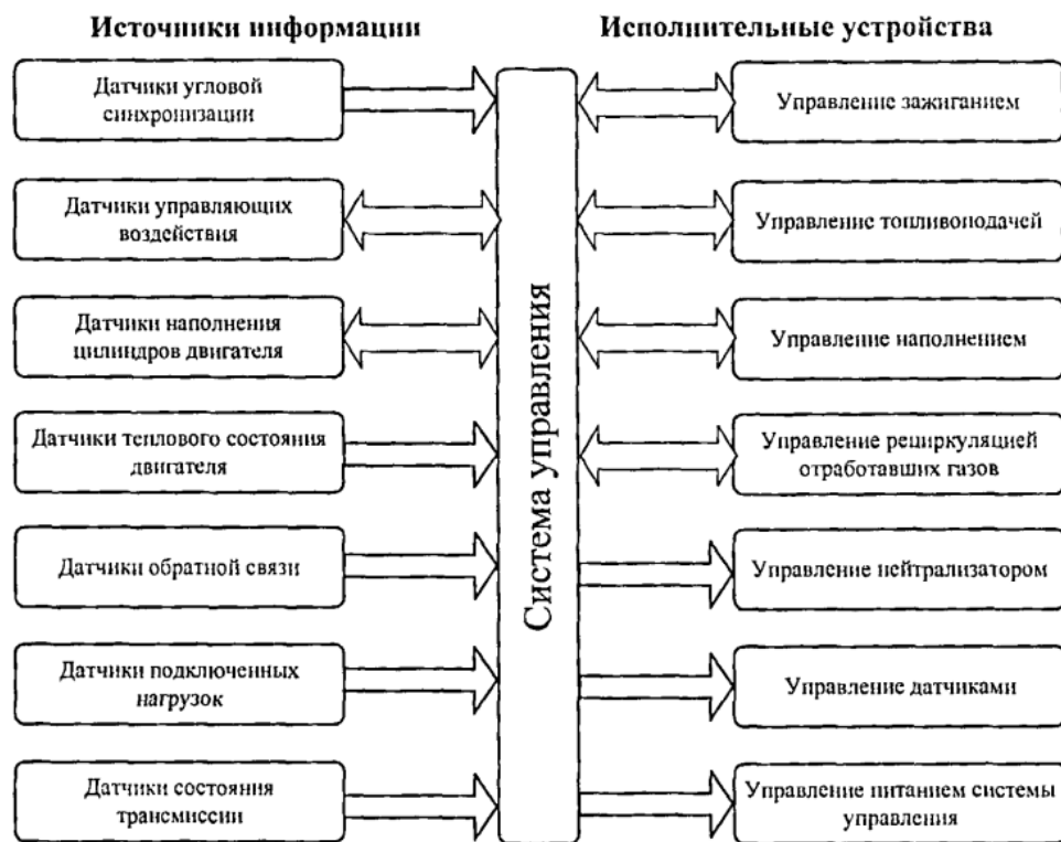
Рисунок 2.7. Структура системы керування робочим процесом двигуна
