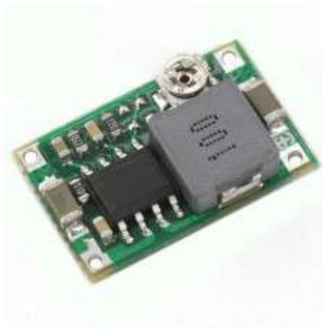
Рисунок 3.1 – DC-DC перетворювач на базі MP1482DS
