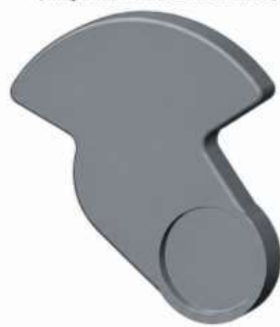
Рис. 17 – Типи контрщок (кулачків) колінчастого вала
