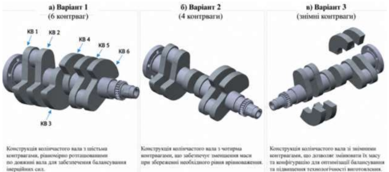
Рис. 18 –Варіанти конструктивного виготовлення колінчастого вала:
