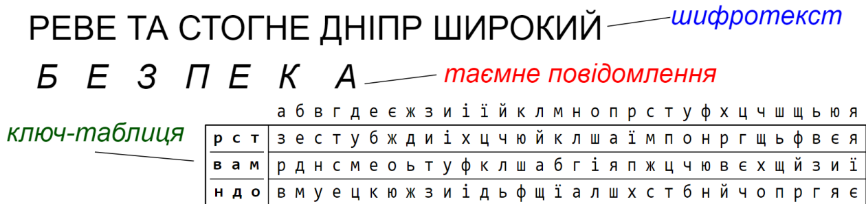
Рисунок 3.8 – Схема роботи алгоритму нелінійного шифрування
