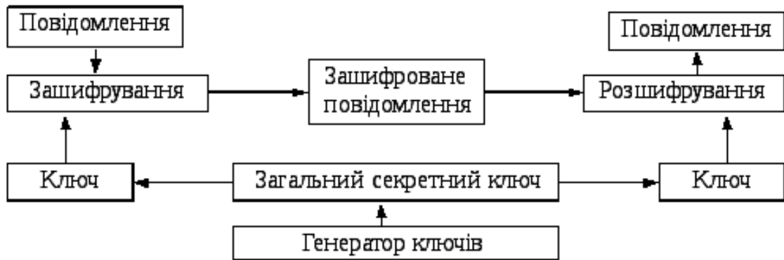
Рисунок 1.2 – Логіка роботи симетричного алгоритму шифрування
