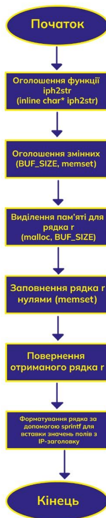
Рисунок 3.9 – Схема перетворення IP-заголовку в строку
