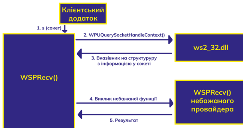
Рисунок 3.3 – Схема обробки запиту recv() у випадку блокуючого чи неблокуючого вводу\виводу
