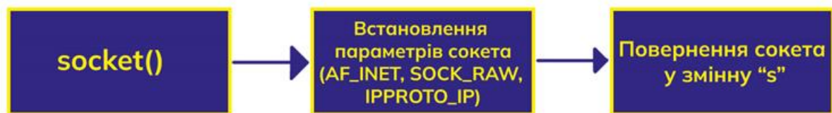
Рисунок 3.5 – Схема створення сирого сокета
