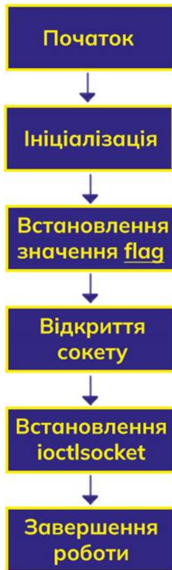
Рисунок 3.4 – Схема роботи процес налагоджування нерозбірливого режиму
