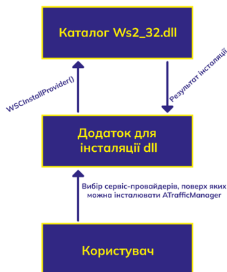
Рисунок 3.1 – Схема роботи додатка для інсталяції сервіс-провайдера
