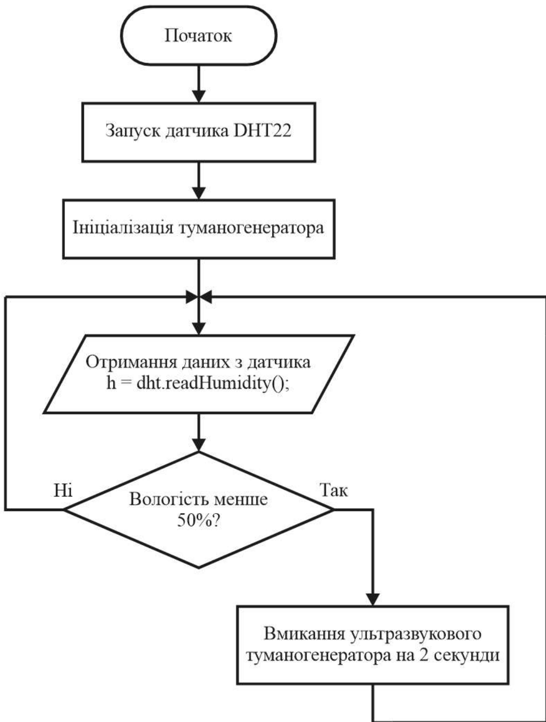
Рисунок 3.9 – Схема роботи туманогенератора з використанням даних з датчика DHT22
