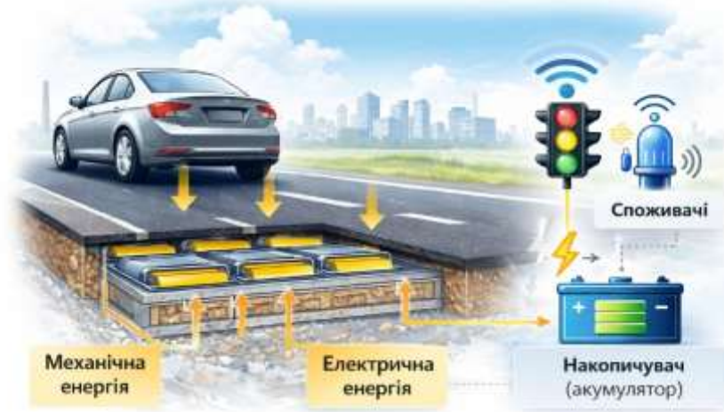
Рисунок 1.2 – Концепція збору механічної енергії в транспортній інфраструктурі
