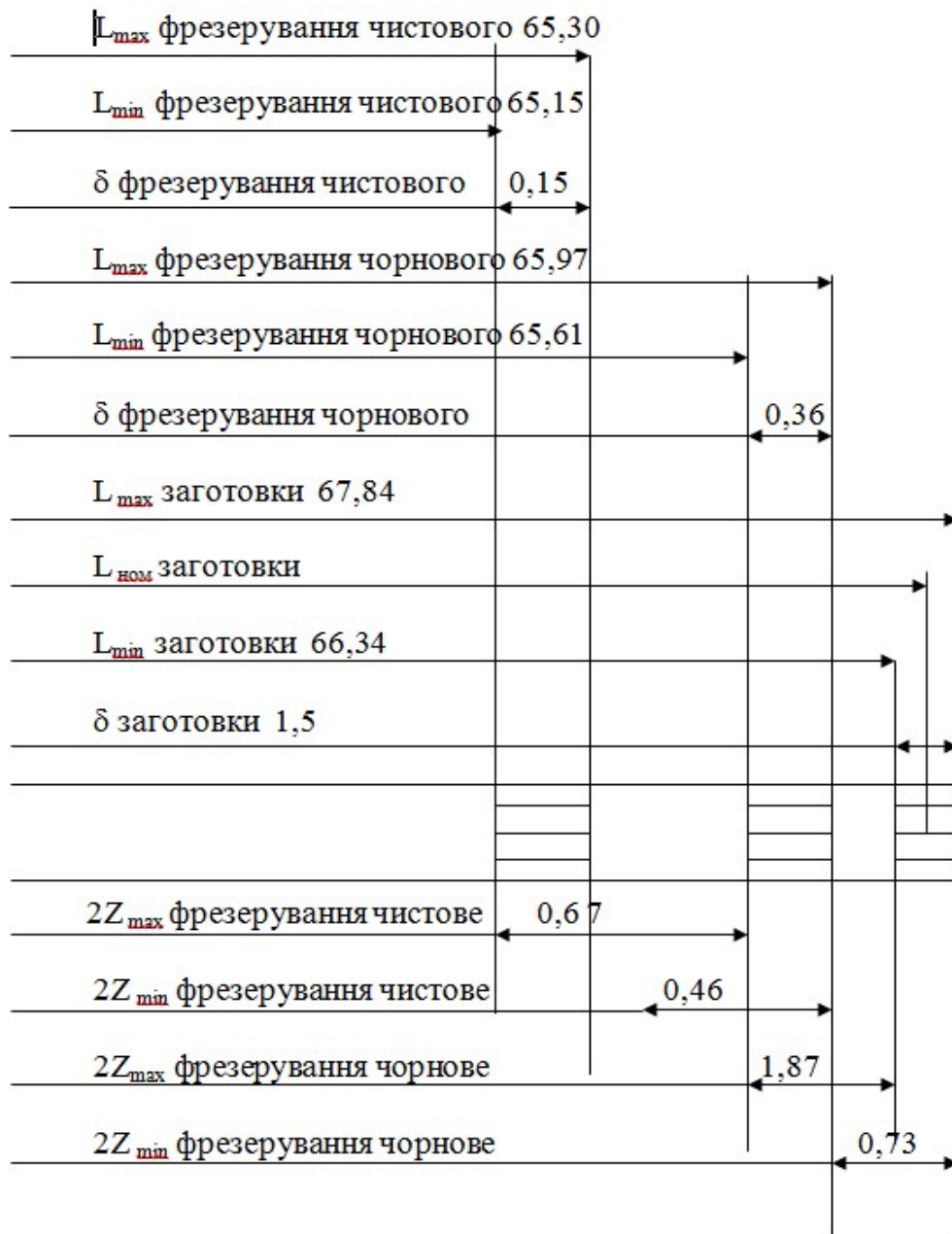
Рис. 2.3 Схема розташовування припусків і допусків на оброблення \varnothing 65_{+0,15}^{+0,3} .
