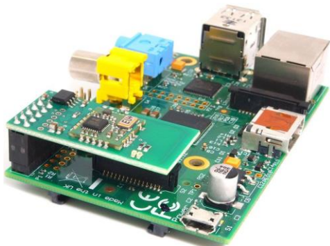
Рис. 8. Зовнішній вигляд платформи Raspberry Pi разом із встановленим модулем Z-Wave RaZberry
