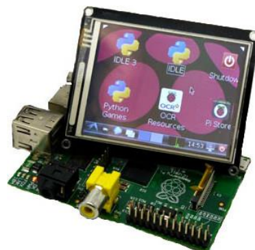
Рис. 9. Зовнішній вигляд 2.8" USB TFT display for Raspberry Pi
