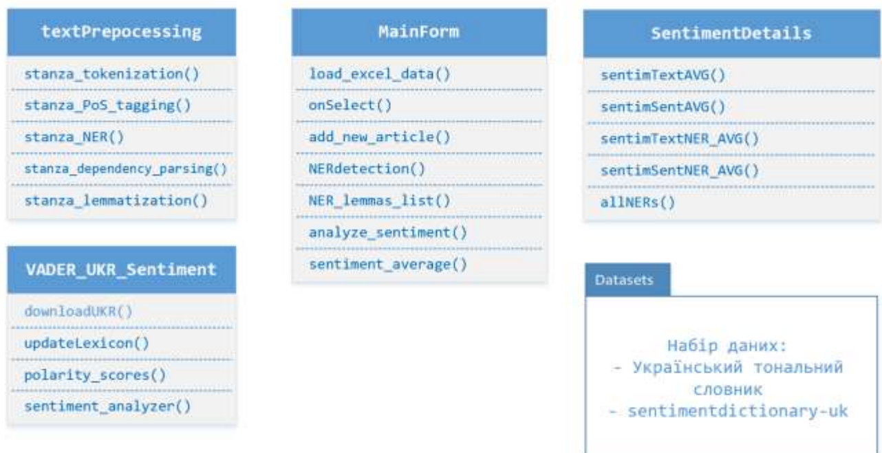
Рисунок 4.1 – Діаграма класів програмного застосунку на базі методу інтелектуального аналізу тональності текстової інформації
