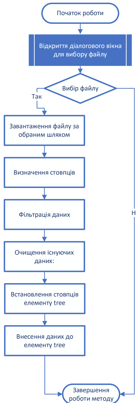
Рисунок 4.2 – Блок-схема методу load_excel_data()
