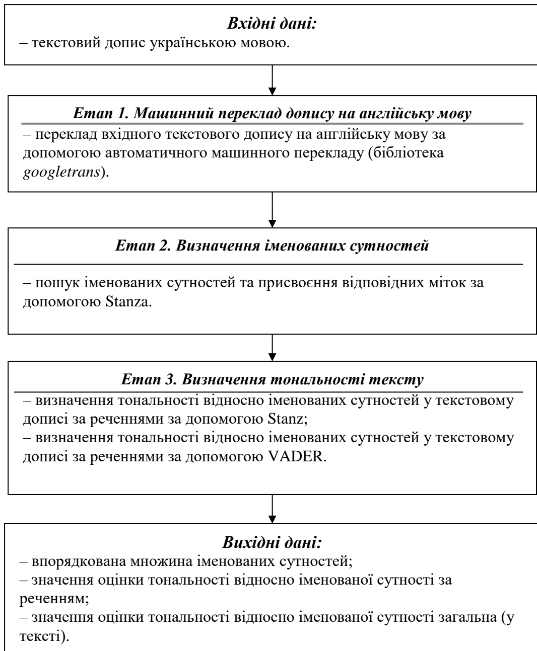
Рисунок 4.10 – Схема роботи додаткового програмного забезпечення для визначення тональності відносно іменованих сутностей
