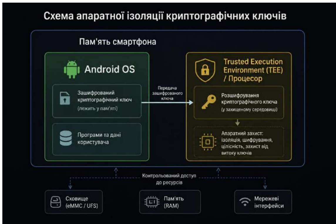
Рисунок 2.4 – Архітектура системи Android Keystore та механізм апаратної ізоляції ключів
