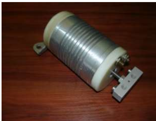
Рисунок 1.22-Зовнішній вигляд магнітоелектричного приводу
