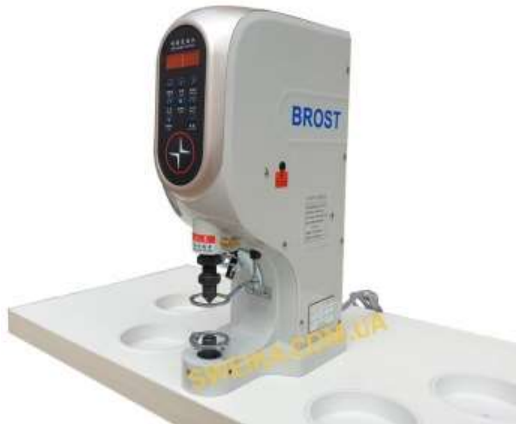
Рисунок 1.12 - Прес для встановлення фурнітури BROS T1 з сервомотором
