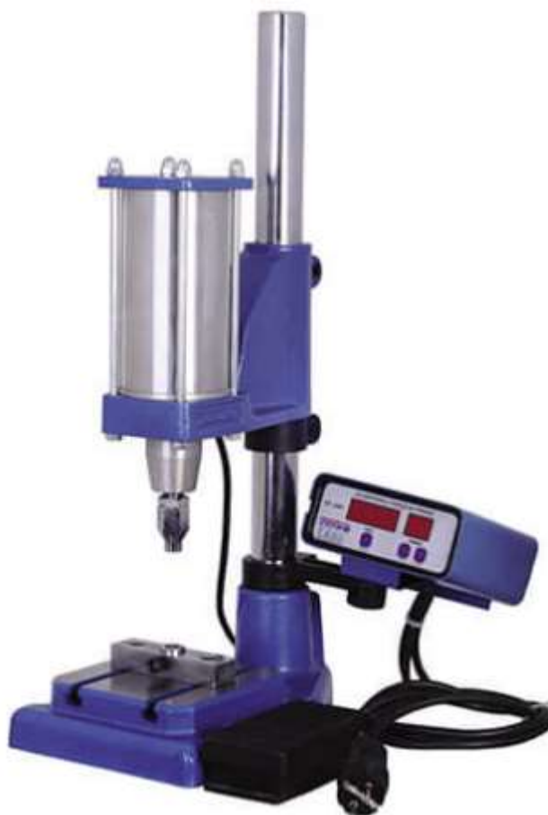
Рисунок 1.10 - Електромагнітний прес для встановлення фурнітури 4389 Presmak
