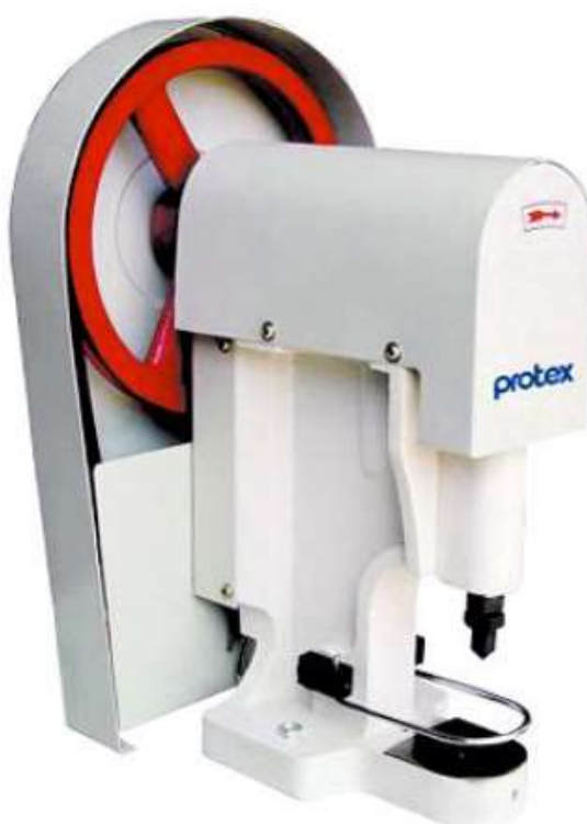
Рисунок 1.13 - Електромеханічний прес для встановлення металеві фурнітури ТУ-818 Protex
