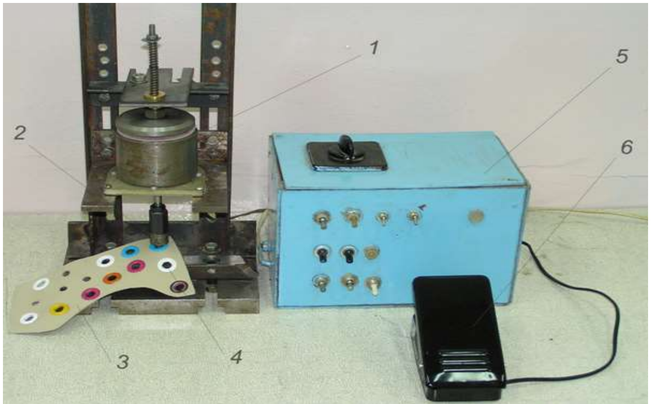
Рисунок 2.18 – Загальний вигляд пресу з магнітоелектричним приводом для встановлення металевої фурнітури
