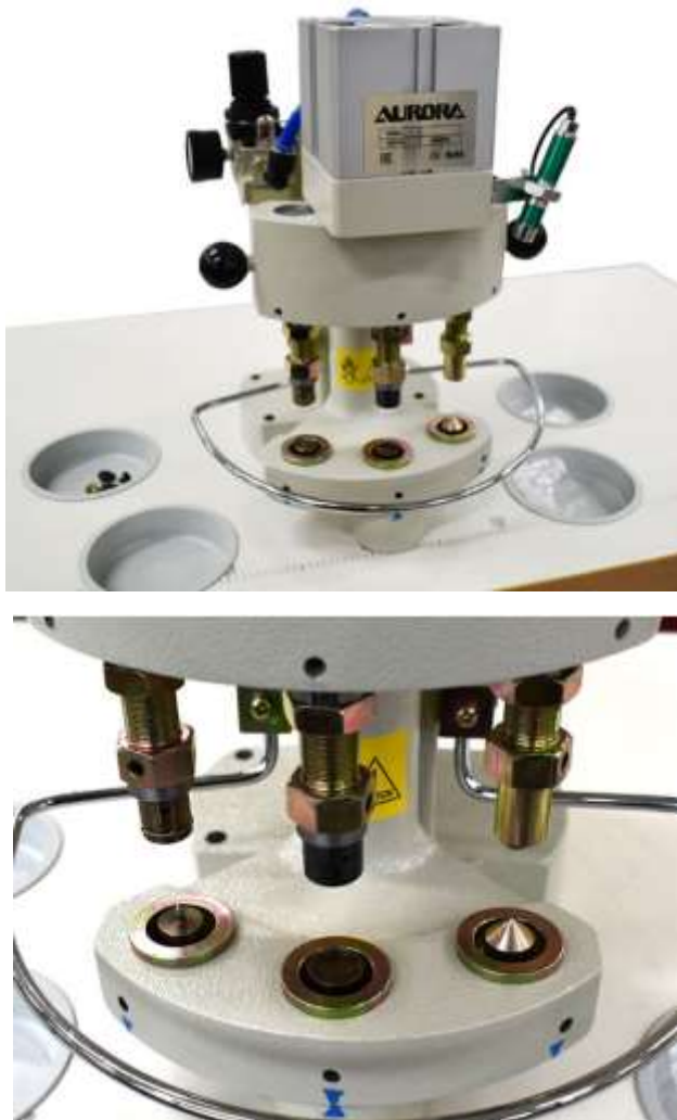
Рисунок 1.8 - Пневматичний прес для встановлення фурнітури J-93-A Aurora
