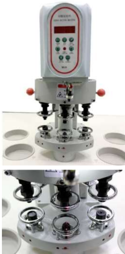
Рисунок 1.9 - Електричний прес для встановлення фурнітури МАХ-М838
