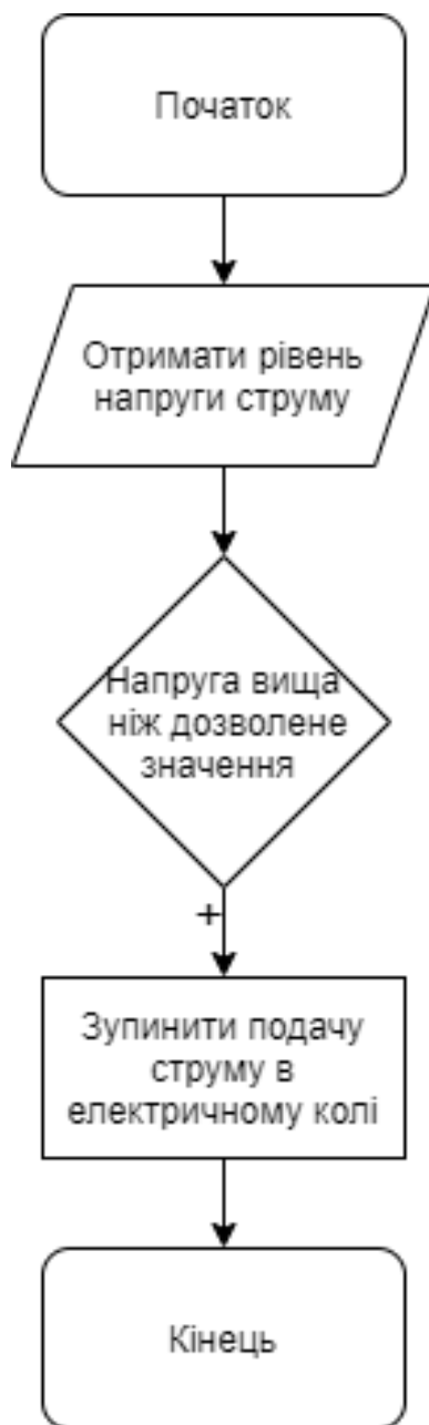
Рис. 1.4 – Алгоритм роботи реле перевантаження
