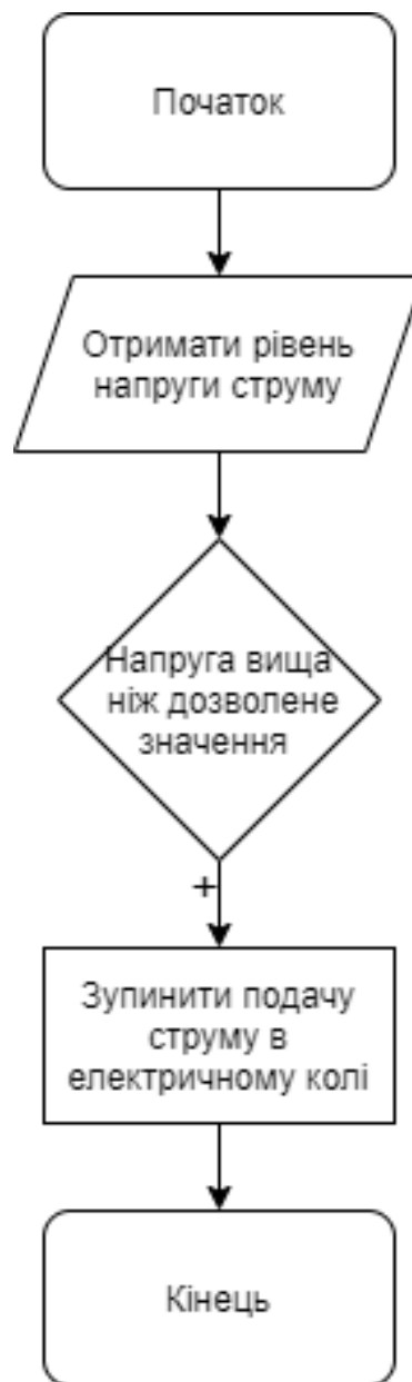
Рисунок 3.16 – Алгоритм роботи модуля реагування на сигнали управління
