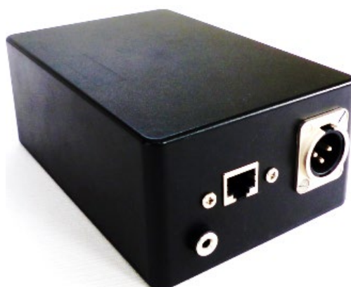
Рисунок 3.11 - Реалізація програмно-технічні засоби реалізації rs-dmx інтерфейсу на основі одноплатної комп'ютерної системи raspberry PI
