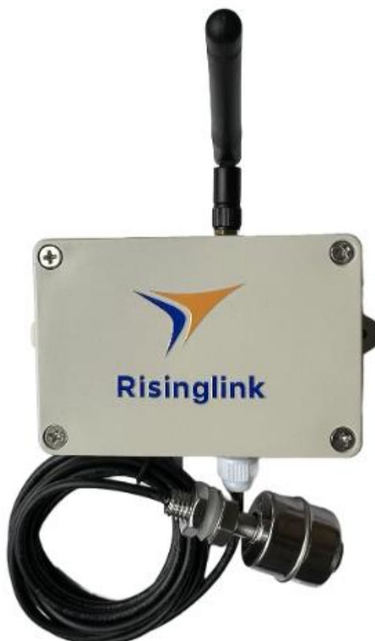
Рис. 2.1 – Датчик Risinglink Smart Monitor для вимірювання рівня води
