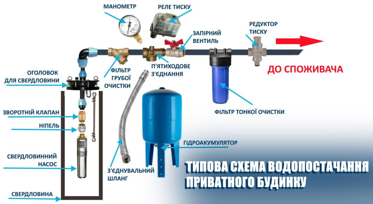
Рисунок 1.3 – Схема автономного водопостачання: основні елементи системи [3]
