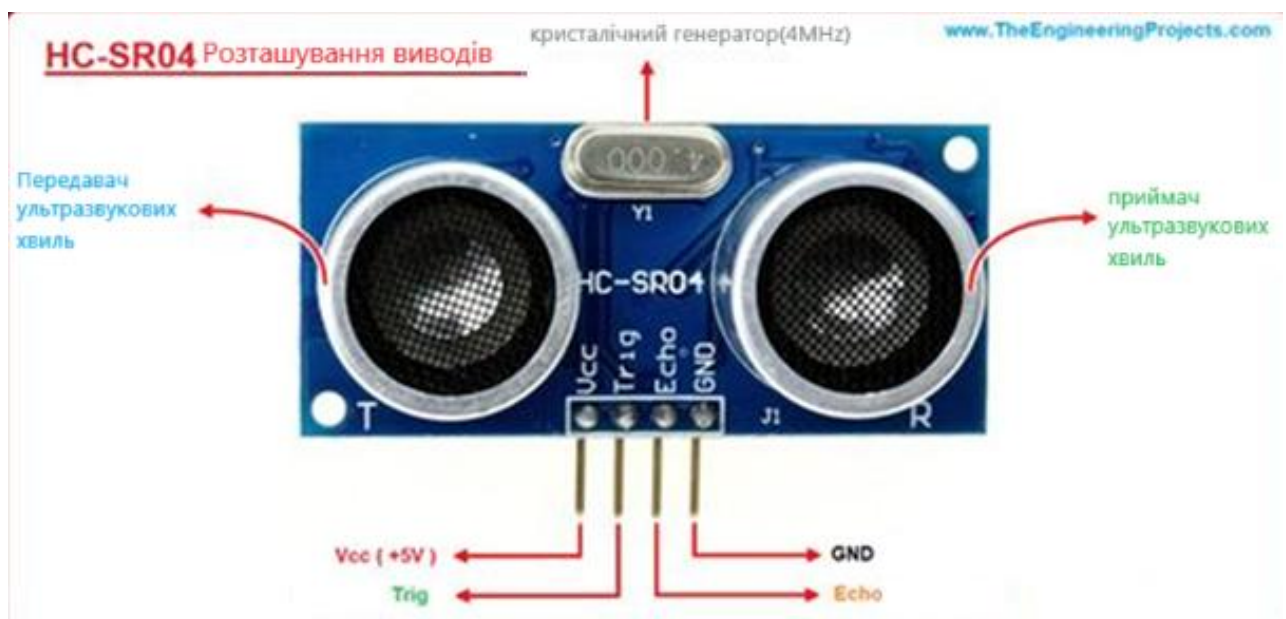
Рисунок 2.6 – Ультразвуковий сенсор відстані HC-SR04 [30]
