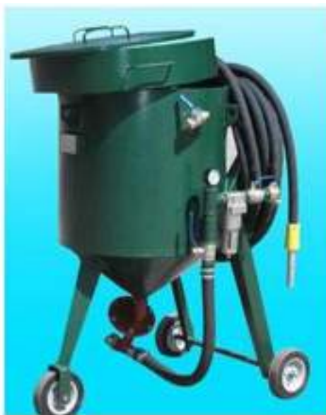
Рисунок 3.4 – Загальний вигляд піскоструминного апарату
