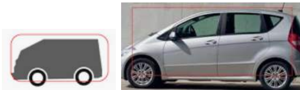
Рисунок 1.3 – Схема одно об'ємного кузова.
