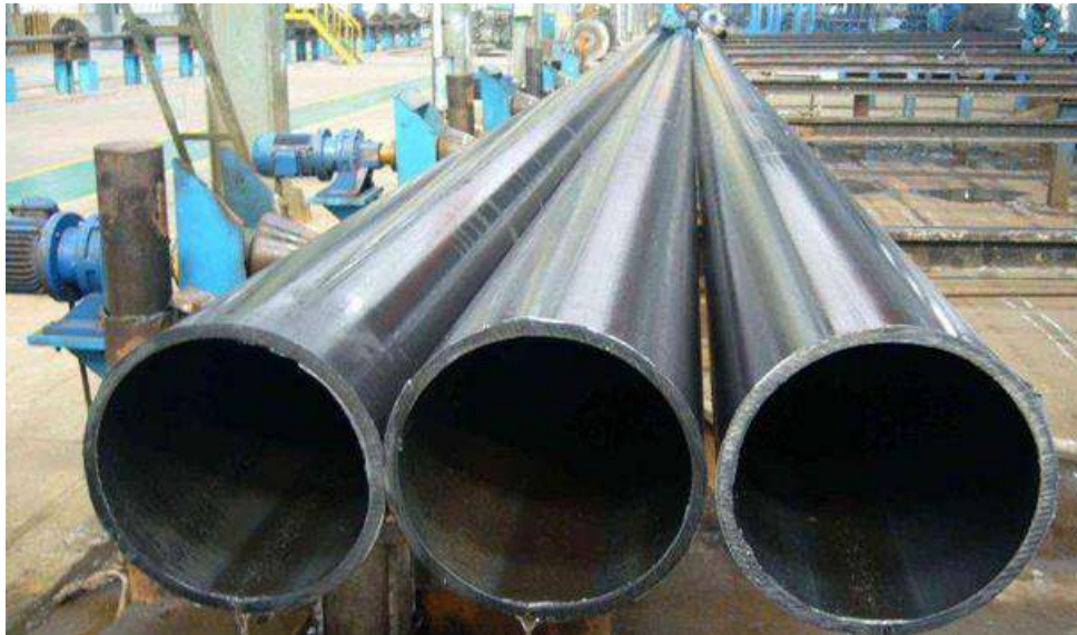
Рисунок 1.5 – Труби, виготовлені з титанового сплаву VT5-1.
