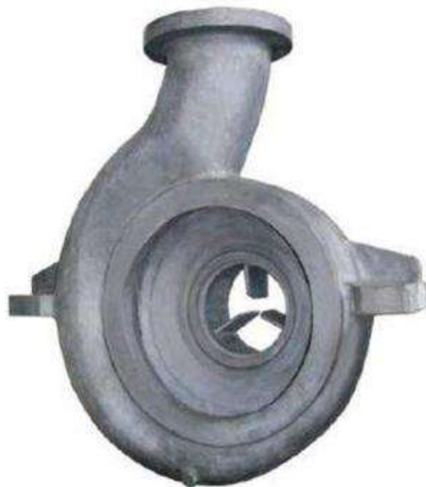
Рисунок 1.9 – Виливка «корпус насоса» для хімічної промисловості, виготовлена з титанового сплаву ВТ1Л
