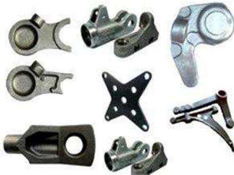
Рисунок 1.11 – Виливки для суднобудування, що виготовлені з титанового сплаву.
