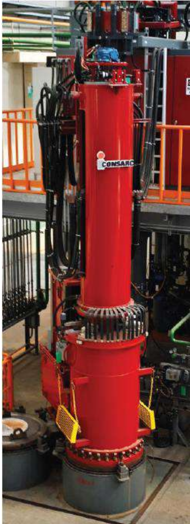
Рисунок 4.2 – Зовнішній вигляд і схема печі «Consarc» VAR:
