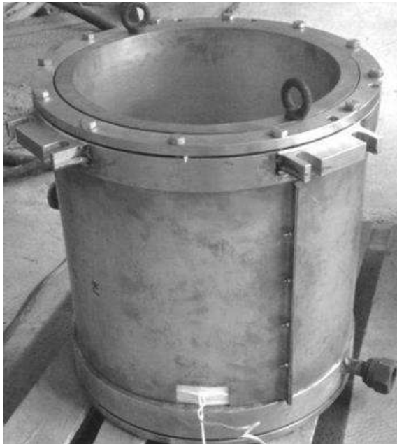
Рисунок 1.15 – Мідний тигель (графітової вставки) для плавки титанових сплавів.
