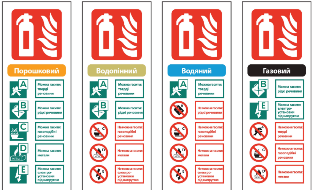
Рисунок 2.25 – Види вогнегасників та їх основні характеристики
