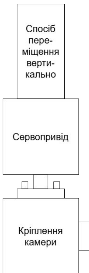
Рисунок 2.7 – Спосіб кріплення сервоприводу до камери
