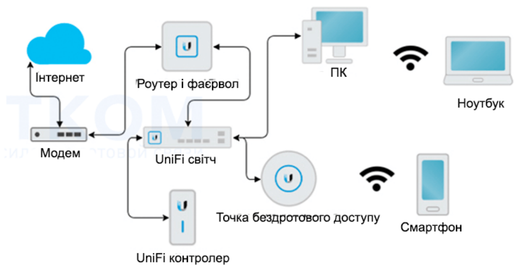
Рисунок 1.3 – Схеми типової і UniFi мереж
