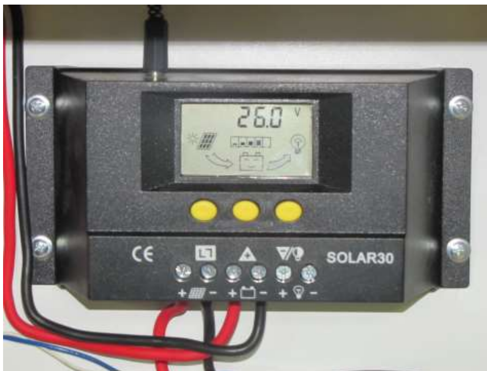
Рисунок 3.7 – Загальний вигляд контролера MPPT SOLAR 30
