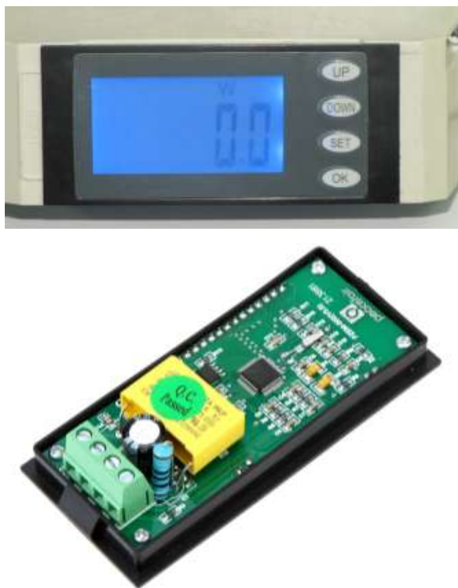
Рисунок 3.11 - Загальний вигляд вмонтованого ватметра в корпус
