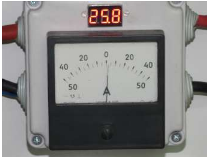
Рисунок 3.9 – Загальний вигляд амперметра із вбудованим вольтметром
