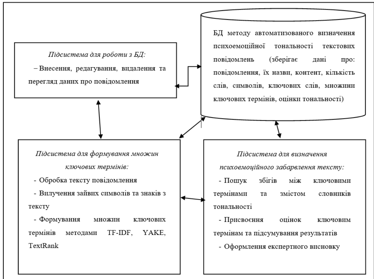
Рисунок 2.2 – Структура компонентів автоматизованої системи визначення психоемоційної тональності текстових повідомлень
