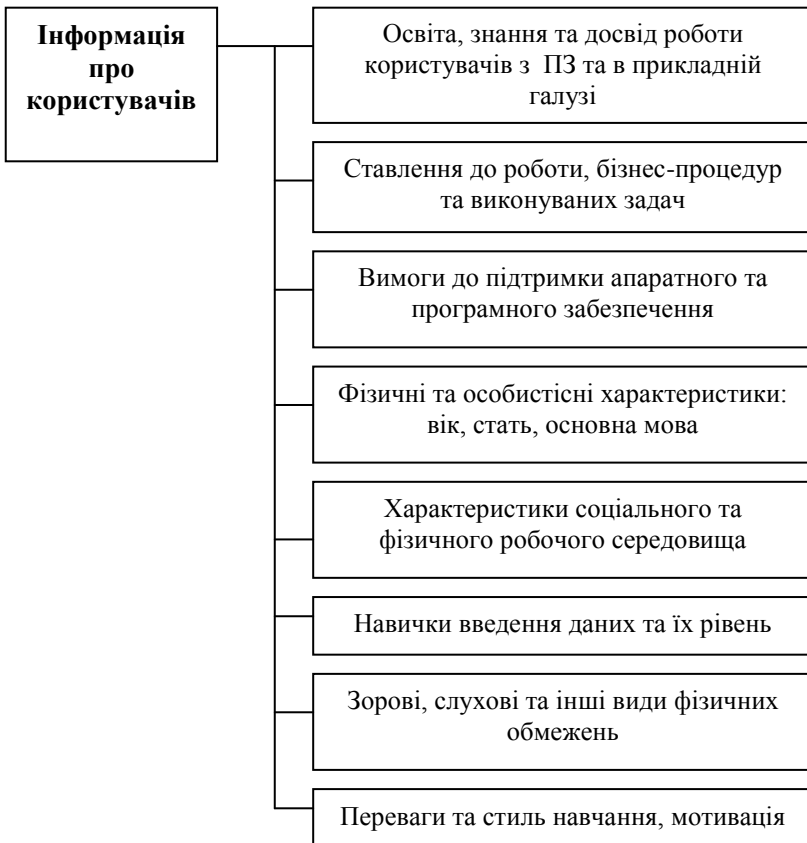
Рис.1.1.2 – Необхідна при проектуванні ІК інформація про користувачів Методи, за допомогою яких відбувається залучення користувачів до проекту, наведені у таблиці 1.1.1.
