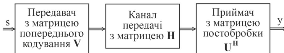
Рисунок 3.2 – Схема каналу MIMO з пре-кодуванням та пост-обробкою
