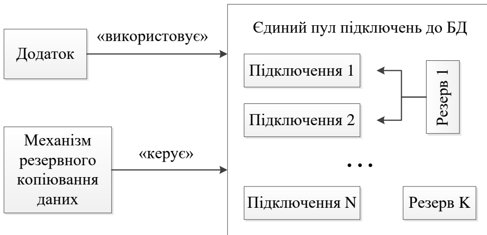
Рисунок 2.4 – Структура програмного модуля із резервуванням підключень до БД
