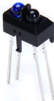
Рисунок 2.2 – Інфрачервоний датчик відбиття світла
