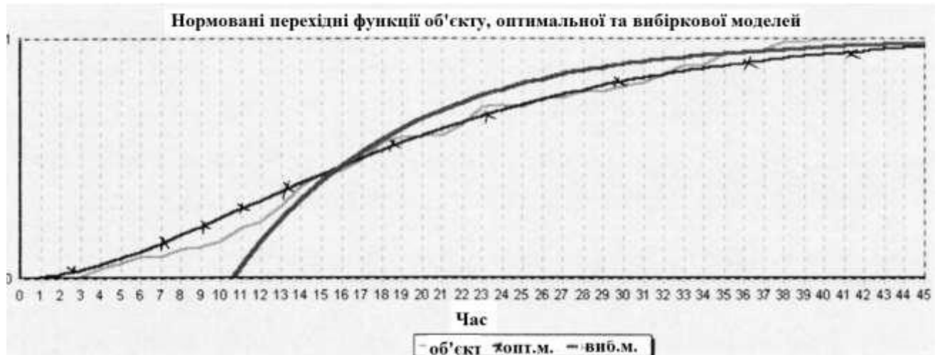
Рисунок 3.9 - Графік нормованих перехідних функцій об'єкта та вибраних моделей
