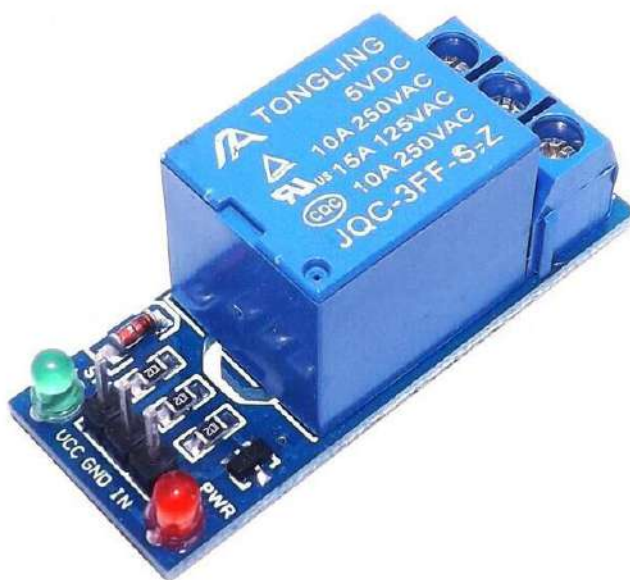
Рисунок 1.7- одно-канальний модуль реле
