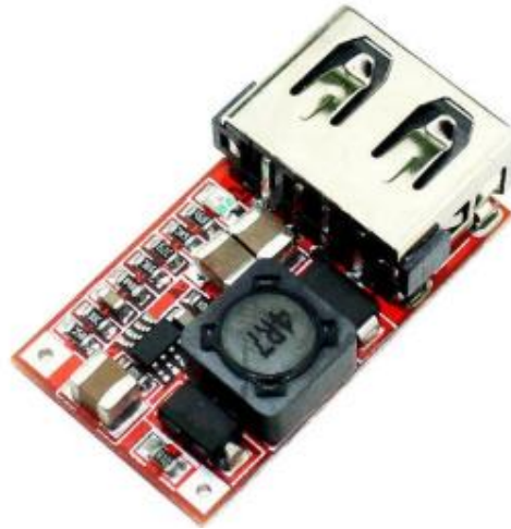
Рисунок 3.17 - Перетворювач напруги знижувальний DC/DC 24 В - 5 В
