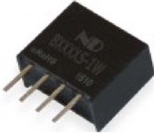
Рисунок 3.18 - Перетворювач напруги знижувальний DC/DC 24 В - 3,3 В
