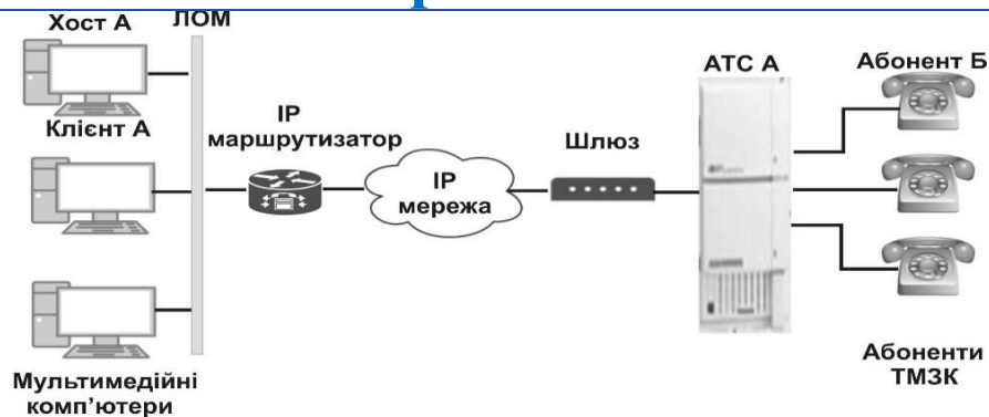
Рис 6.2 – Схема VoIP виклику «від хосту клієнта А локальної мережі до телефонного апарату абонента Б мережі ТМЗК АТС Б»
