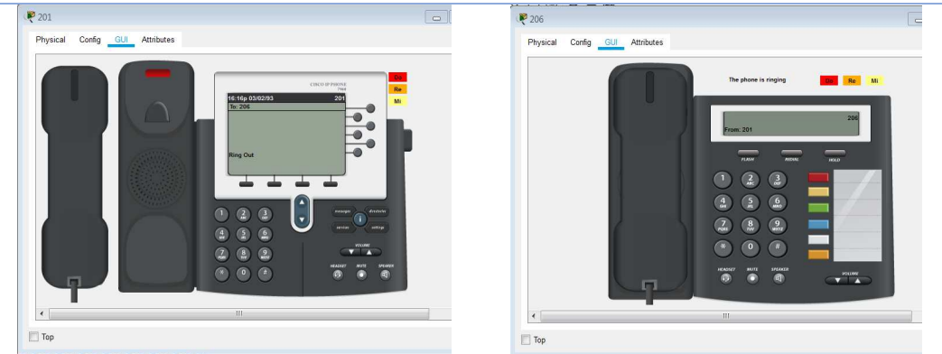
Рисунок 8.3 – Процес ініціювання вхідного виклику з IP SIP телефону з номером 201 на аналоговий телефон з номером 206
