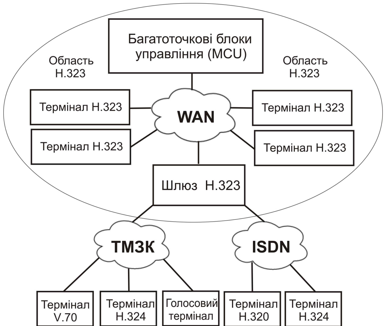
Рисунок 1.2 - Типи кінцевих точок Н.323
