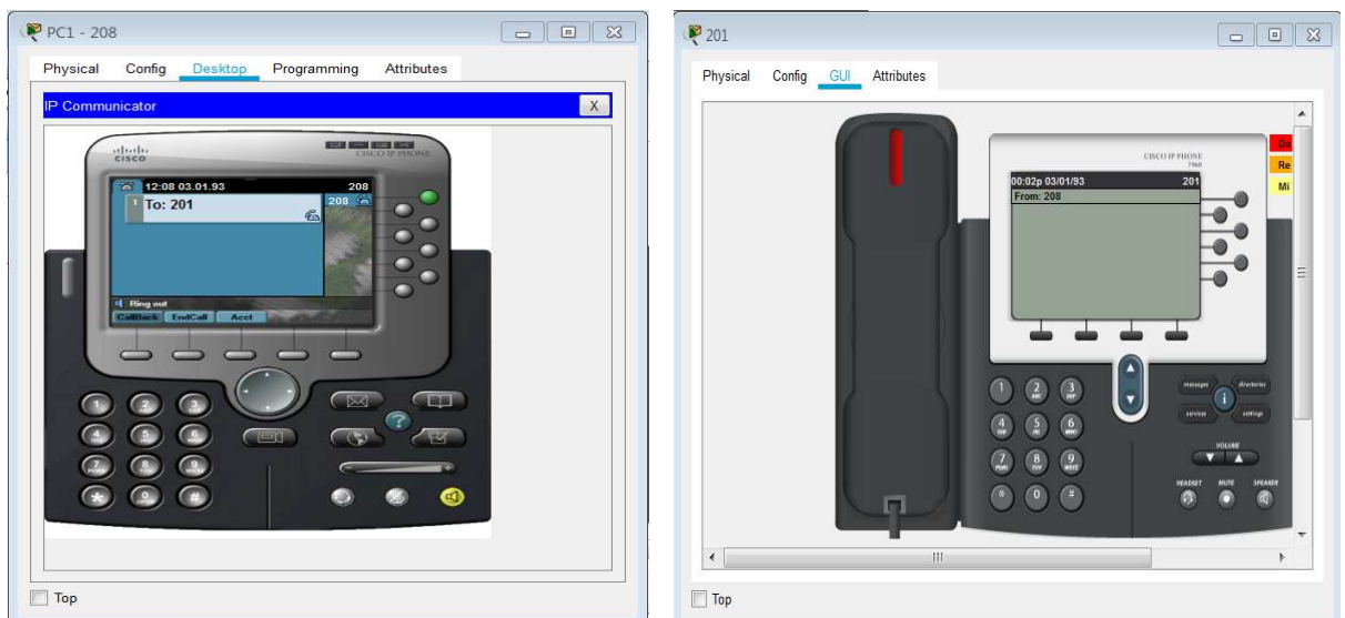
Рисунок 2.7 - Ініціювання виклику з PC1 з номером 208 на номер 201 IP-телефону
