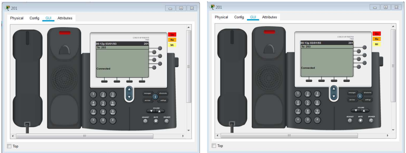
Рисунок 2.5 – Встановлення з'єднання між двома IP – телефонами з номерами 201 та 203
