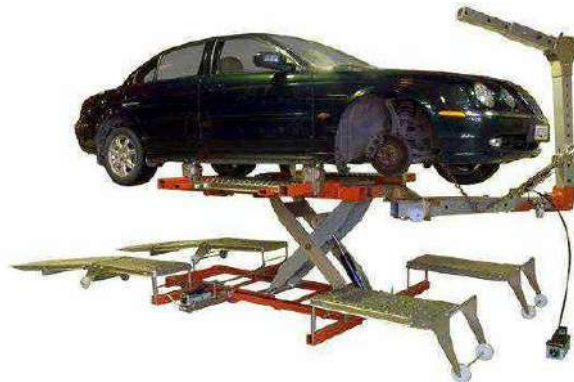
Рисунок 3.7 - Приклад стану для відновлення геометричних розмірів кузова або рами - стапель Autorobot XLS++
