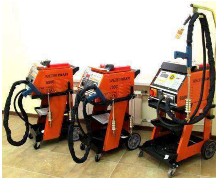
Рисунок 3.10 - Модельний ряд споттерів WIEDERKRAFT для виконання робіт із вирівнювання поверхні та одностороннього точкового зварювання
