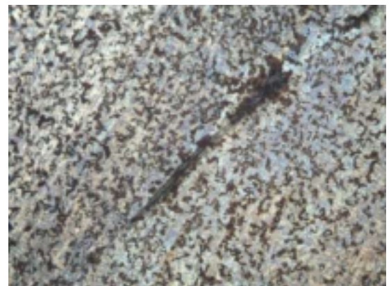
Ділянка пресового з'єднання при дії магнітного поля (x200)
