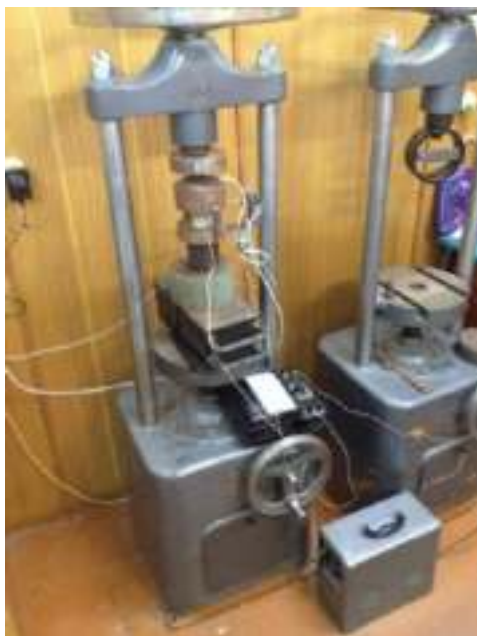
Рисунок – 2.16. Загальний вид установки для дослідження сили зриву посадки з натягом із зазором у магнітопроводах (пластини з боків)
