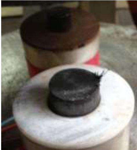
Рисунок – 2.12. Електромагнітні котушки установки та досліджувані зразки
