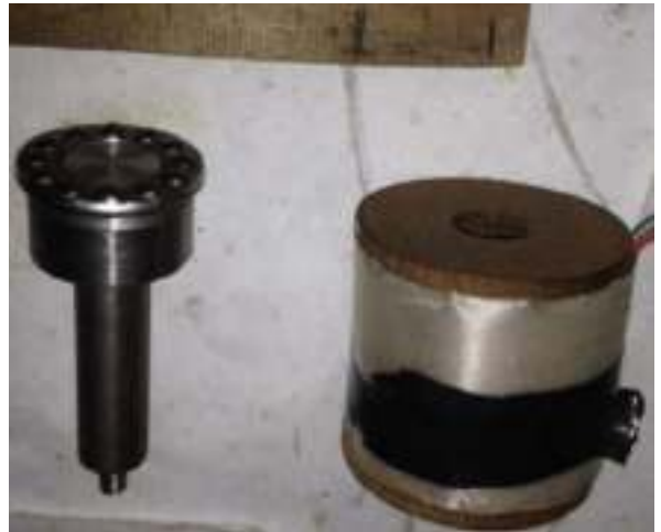
Рисунок – 2.12. Електромагнітні котушки установки та досліджувані зразки
