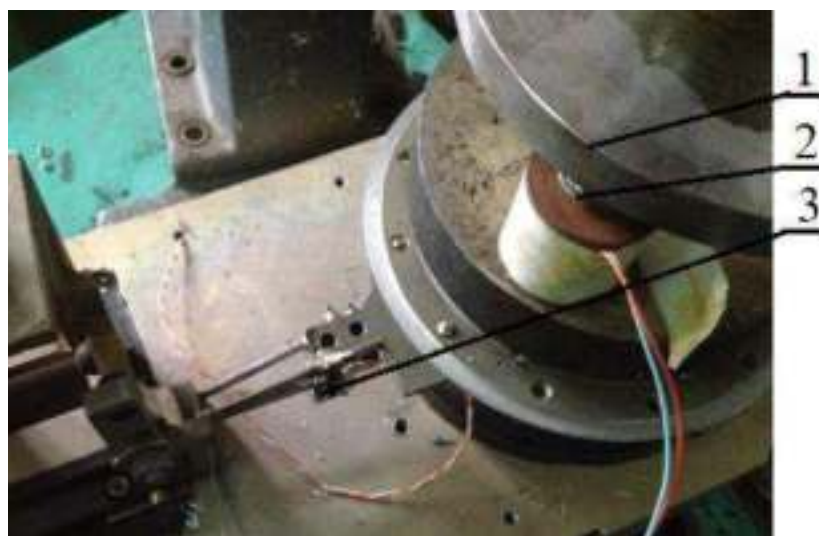
Рисунок – 2.14. Трибومتر для випробувань пари тертя «палець –
