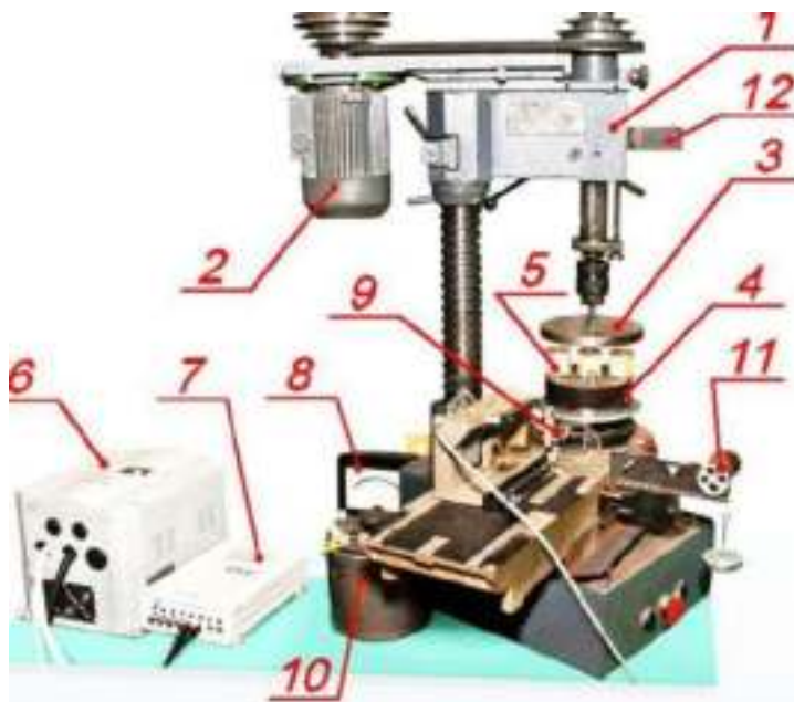
Рисунок – 2.11. Установка для проведення випробувань пар тертя ковзання під впливом магнітного поля
