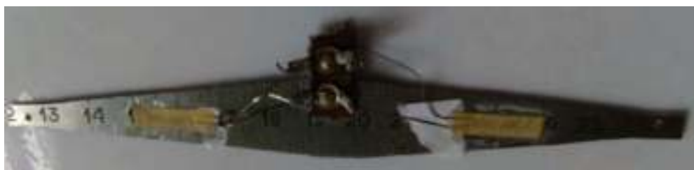
Рисунок – 2.7. Загальний вигляд тензобалки Однокульковий трибометр (рисунок 2.8), містить обмотку 4 створює
