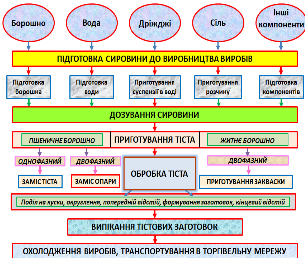
Рис. 2.1. Загальна блок-схема технології виробництва хлібобулочних виробів
