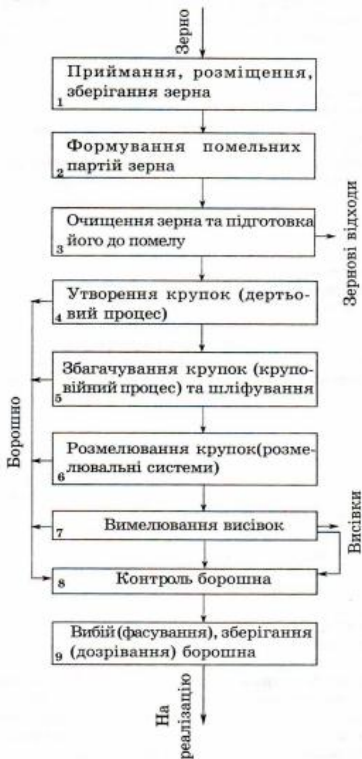
Рис. 1.1. Принципова технологічна схема виробництва борошна
