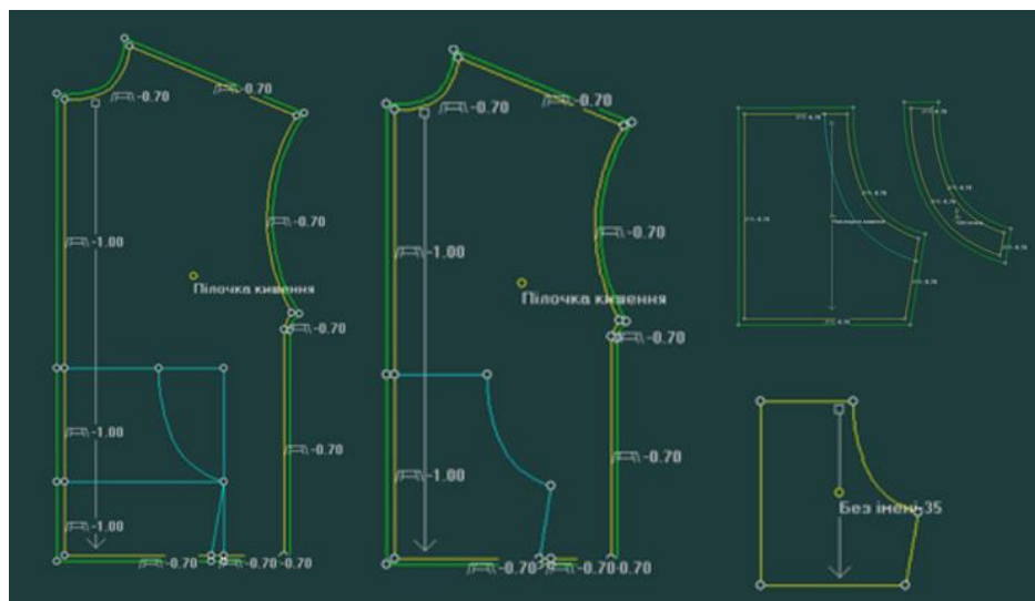
Рисунок 2.5 - Знімок екрана робочого поля АРМ Конструктор САПР «JULIVI» із моделюванням накладної кишені, лекала накладної кишені та обшивки кишені
