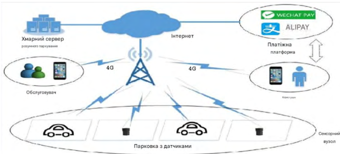
Рисунок 1.5 – Принцип роботи Nb-IoT
