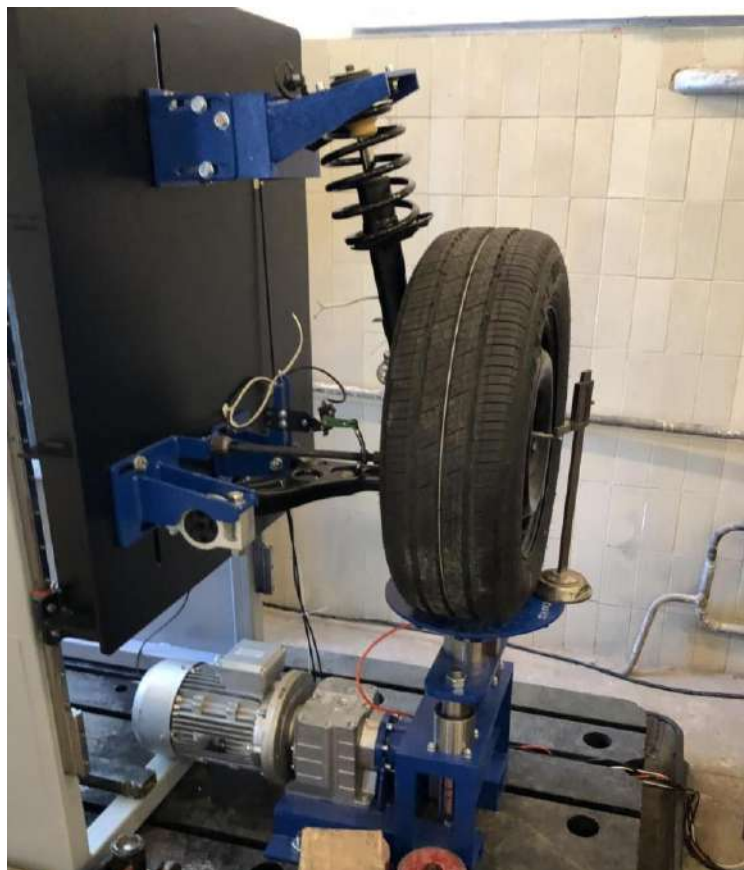
Рисунок 3.9 – Зовнішній вид стенду «Система керування адаптивною підвіскою»
