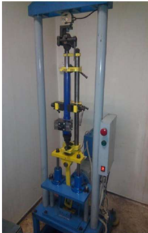
Рисунок 3.8 – Зовнішній вигляд стану випробувань амортизаторів
