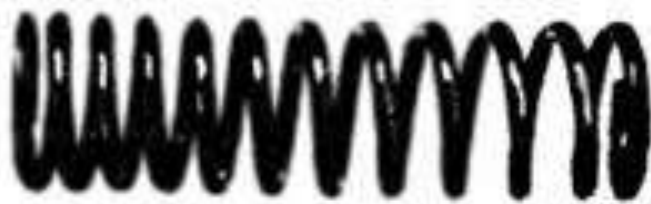
Рисунок 1.6 . Гвинтова пружина з нелінійною робочою характеристикою, що реалізується за рахунок різного кроку намотування
