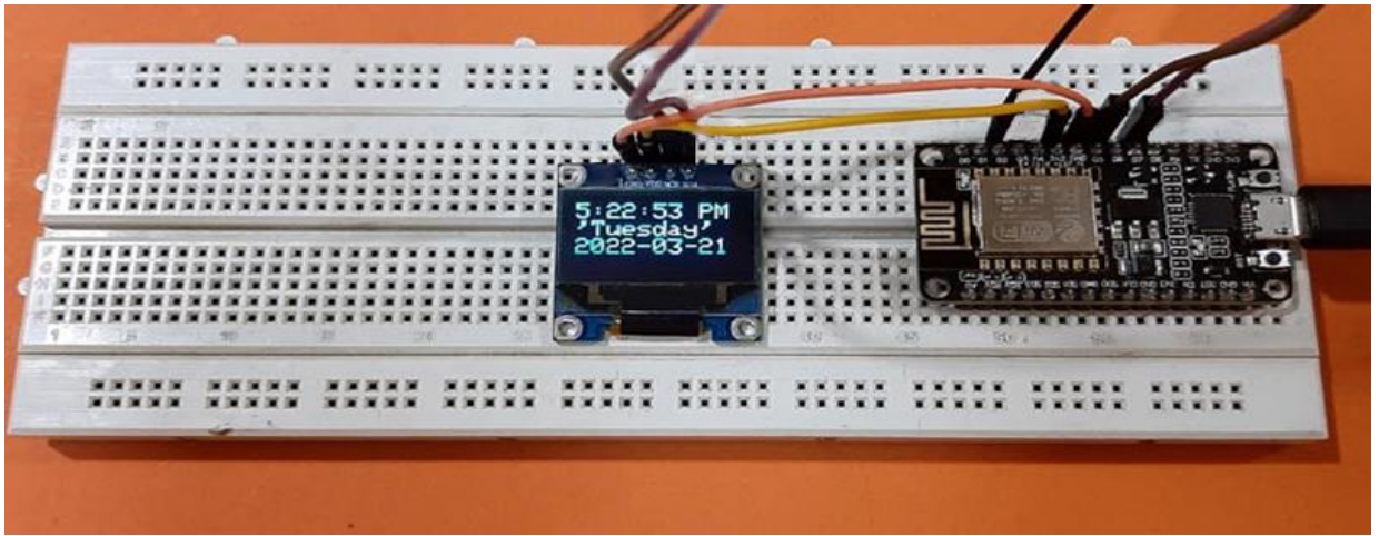
Рисунок 3.12 – Макет робототехнічної СКЧС з використанням МК ESP8266
