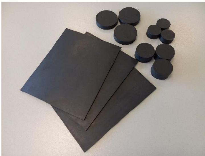
Рисунок 3 - Зразки еластомерів для випробувань у вигляді з вулканізованих пластин і циліндрів
